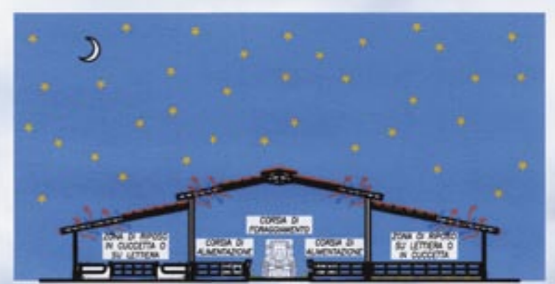
Nelle ore notturne della stagione estiva la "stalla aperta" favorisce lo scambio termico ed ottiene i benefici derivanti da una maggiore ventilazione e da un più rapido abbassamento della temperatura.
